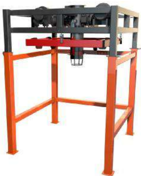
ГПУ – рамная конструкция, подвешенная на датчики
