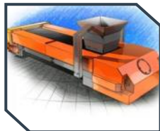
Ленточный весовой дозатор непрерывного действия
